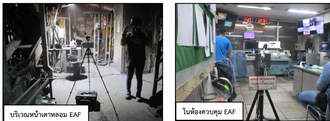
ภาพที่ 3.38 การตรวจวัดเสียง Leq 12 ชั่วโมง บริเวณหน้าเตาหลอม EAF
